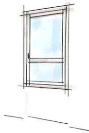
FINESTRA A UN BATTENTE CON UNA TRAVERSINA
