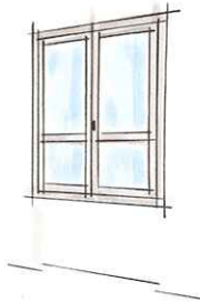
FINESTRA A DOPPIO BATTENTE CON UNA TRAVERSINA
