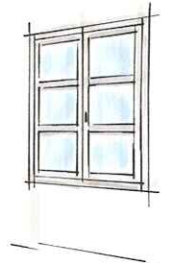
FINESTRA A DOPPIO BATTENTE CON DUE TRAVERSINE
