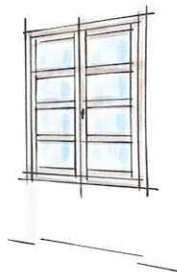
FINESTRA A DOPPIO BATTENTE CON TRE TRAVERSINE
