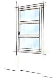
FINESTRA A UN BATTENTE CON DUE TRAVERSINE
